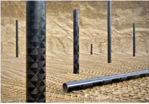
Kohlefaserbewehrte Formholzprofile, Peer Haller et al. 2009, Technische Universität Dresden, Foto: L. Sprenger
