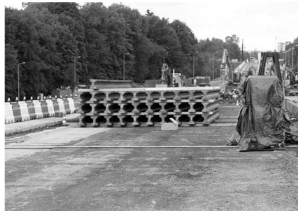
Bild 2: 31 von 38 Stahlbrammen (Halbzeuge) als Versuchslast
