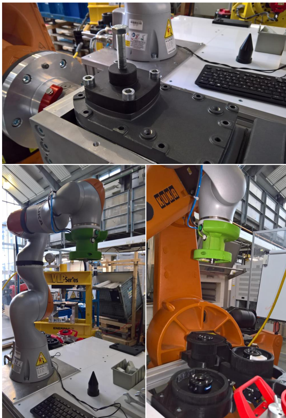
Abbildung 54: Lösen des Getriebedeckels, erster Teil.
