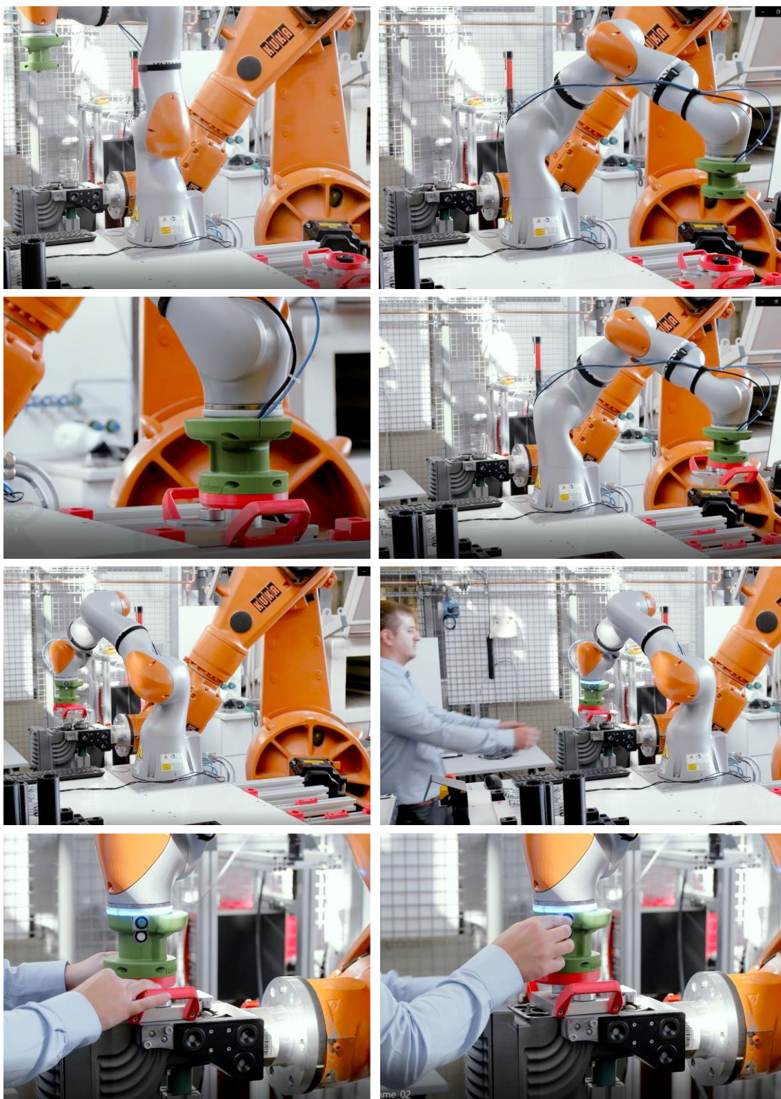
Abbildung 57: Entnahme des Getriebesatz, erster Teil.
