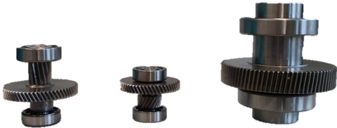
Abbildung 35: Die Getriebestufen des Motors.
