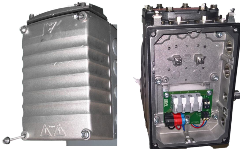
Abbildung 37: Der Elektronikkasten des Motors.
