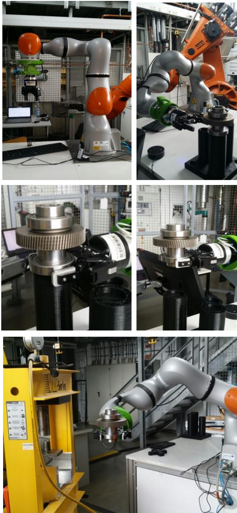
Abbildung 59: Auspressen der Zahnräder und Kugellager, erster Teil.
