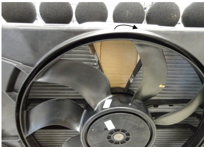
Bild 15: Abklebung eines Segmentes mit Pappkarton zu Testzwecken
